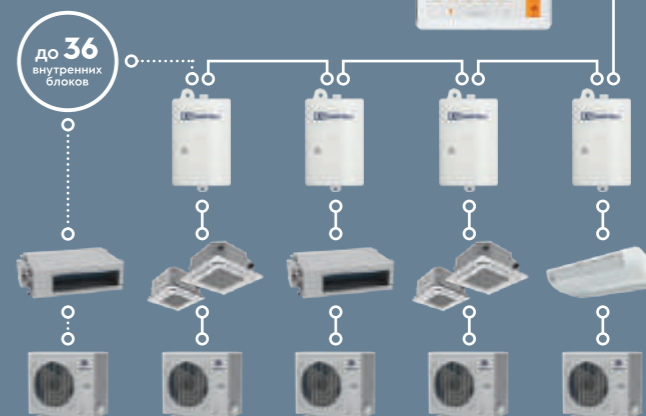
Схема управления кондиционирования в BMS
